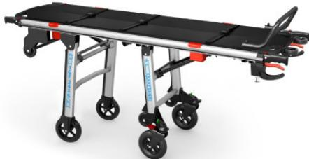
Ce chariot brancard funéraire en aluminium totalement peint en gris possède un plateau en Inox. 2 **roues pivotantes Ø200** à l'arrière et roues avant fixes. Kit ceintures pour les épaules, l'abdomen et les jambes. Le **plateau supérieur est extractible** et possède des roues pour le transport. 1 position intermédiaire et 4 poignées télescopiques. *Pour toute demande d'informations sur ce produit, merci de bien vouloir nous faire une demande de devis ou de renseignements complémentaires.*
