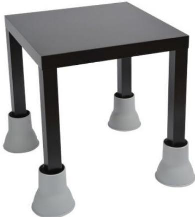
Ils se disposent **sous les pieds de votre lit ou de votre chaise** **afin d'en augmenter la hauteur**. Conception pieds d'éléphant permettant de résister à un poids de 380 Kg. **Partie supérieure large pouvant recevoir la plupart des pieds de meubles.** Renforcement central permettant de positionner une roulette en toute sécurité.
