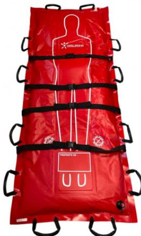
Composé de 2 toiles de PVC, soudées en périphérie par Haute fréquence pour constituer une enveloppe étanche. Il est rempli par des billes polystyrène. **4 sangles patients et 12 poignées sur toute la périphérie.** Valve 1/4 de tour se démontant pour un remplissage ultérieur de billes. **Radio Transparent. Dimensions 90 x 220 cm. Conforme à la norme EN1865.**
