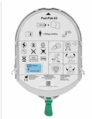
Ce Pad-Pak est composé d'électrodes adulte et d'une batterie contenues dans une cartouche à usage unique. Pour enfants de plus de 8 ans et pesant plus de 25 kg . Le Pad-Pak est compatible avec les défibrillateurs 350P, 360P et 500P. Il permet de délivrer 60 chocs ou 6 heures de suivi continu. Durée de vie de 4 ans.
