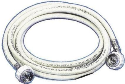
L'emboufix est un flexible basse pression de raccordement pour fluide médicaux. **Il alimente les appareils médicaux à partir d'une prise crantée normalisée.** Durée de vie de 10 ans. Sans latex et sans odeur. Haute résistance à l'éclatement, la traction et l'écrasement.
